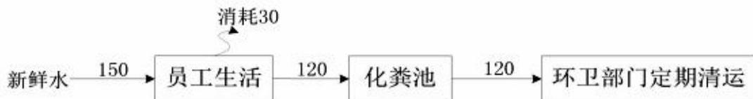
图 2-1 项目用水平衡图（单位 m<sup>3</sup>/a）
