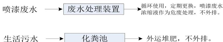
图3-1 项目废水处理流程图
