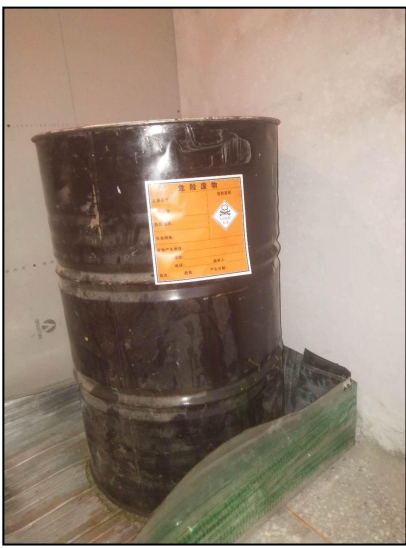
废油桶及防渗漏托盘
